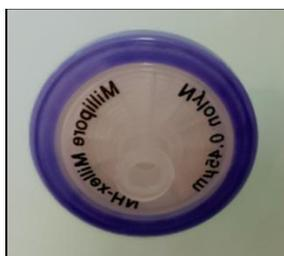
**Figure 25** filtre seringue de 0.45µm.
